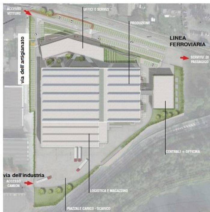
Figura 19- Punti di accesso previsti per mezzi leggeri e pesanti in seguito a nuovo stabilimento Rigamonti
